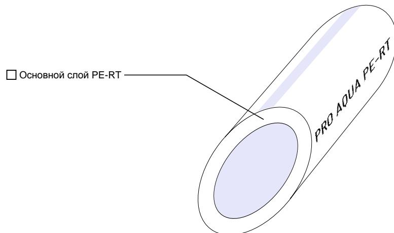
1.3 Труба напорная Pro Aqua из полиэтилена повышенной термостойкости (PE-RT) SDR 7.4 производится в белом цвете.
