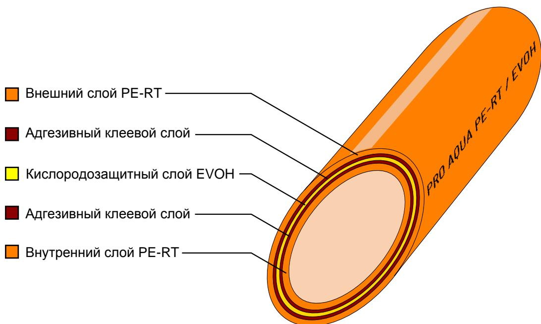
1.3 Труба напорная Pro Aqua из полиэтилена повышенной термостойкости (PE-RT) с кислородозащитным слоем EVOH S 3.5 / S 4.5 производится в оранжевом цвете.
